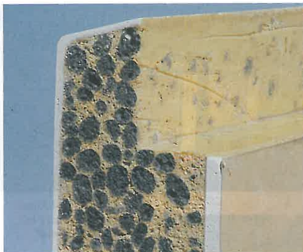
Abb. 8.3: E-UP-Leichtbeton (asymmetrischer Wandaufbau), von außen nach innen: circa 3 mm GF-UP Laminat (farbig pigmentiert), angeschäumte Matte (450 bis 600 g/qm), 15 bis 20 cm E-UP-Leichtbeton, angeschäumte Matte, 16 bis 22 mm Gipskarton (mit Aluminium-Folien-Einlage auf der LB-Seite)
