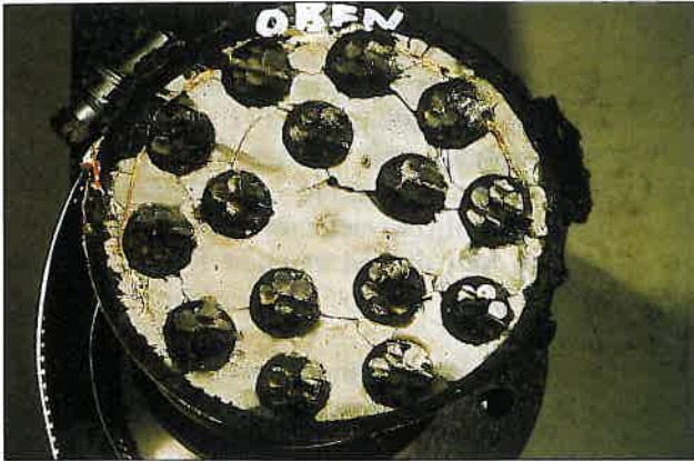
Abb. 9: Spannglied der Fa. D+W, parallel geführte Monolitzen mit Zementverpressung
