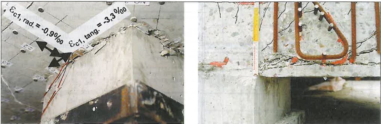
Abb. 23: Versagensformen im Bereich mit Durchstanzbewehrung
