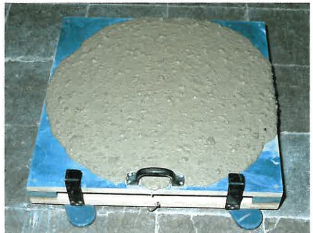
Abb. 9: Ausbreitmaß des Selbstverdichtenden Betons (rd. 70 cm ohne Schlag)
