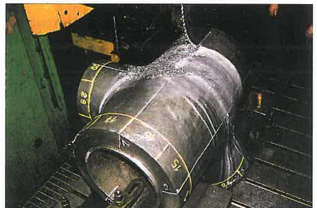
Abb. 32: Bogenknoten mit gekennzeichneten Fehlstellen, unten Zersägen des Bogenknotens
