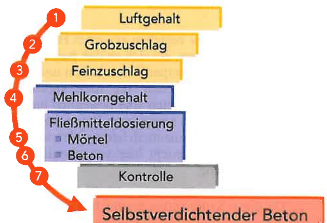
Abb. 4: SVB-Rezepturentwicklung nach Okamura – „General Purpose Approach“
