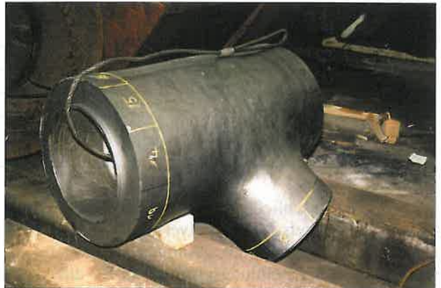
Abb. 31: Stützenfuß mit angezeigten Fehlern, rechts zersägt
