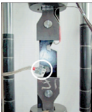
Abb. 38: Proben des Eckausschnittes und Detailvergrößerung
