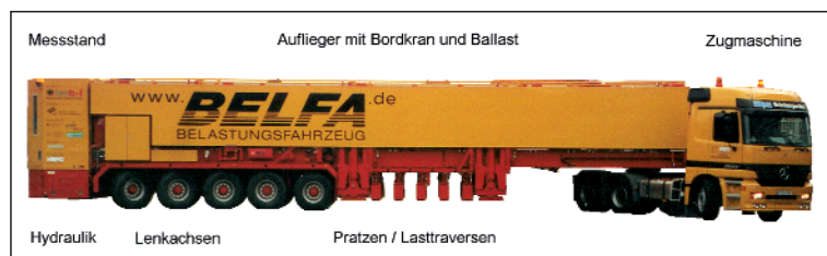
Abb. 3: Funktionselemente des Belastungsfahrzeuges
