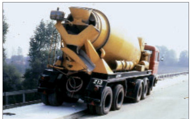
Abb. 6: Rechnerische Gebrauchslast auf einem Kragarm, Mischerfahrzeug mit Kies beladen
