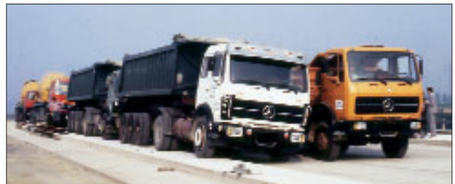
Abb. 5: Rechnerische Gebrauchslast auf einem Hauptträger, Fahrzeuge voll mit Kies beladen
