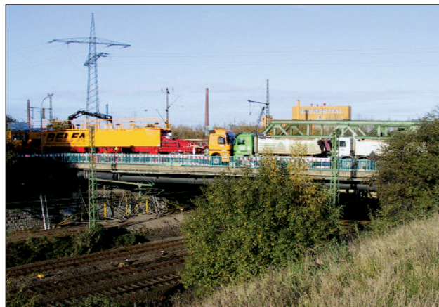
Abb. 11: Versuchsaufbau: Oben BELFA und LKW; Unten: Messbasis (gelb)
