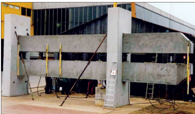
Abb. 15: Prüfung von zwei Fertigteilbalken
