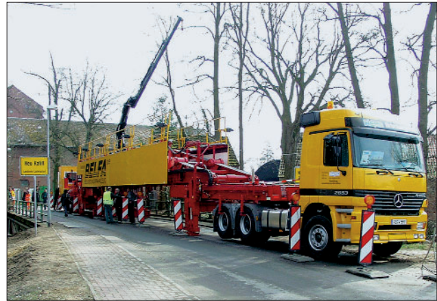
Abb. 10: Belastungsfahrzeug BELFA in Versuchsposition (Neu Kaliß)
