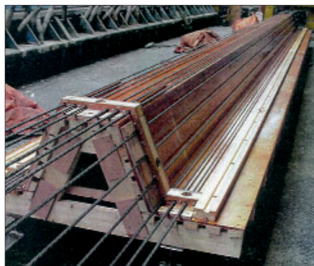
Abb. 14: Schalung für eine vorgespannte Spundwand aus hochfestem selbstverdichtendem Faserbeton
