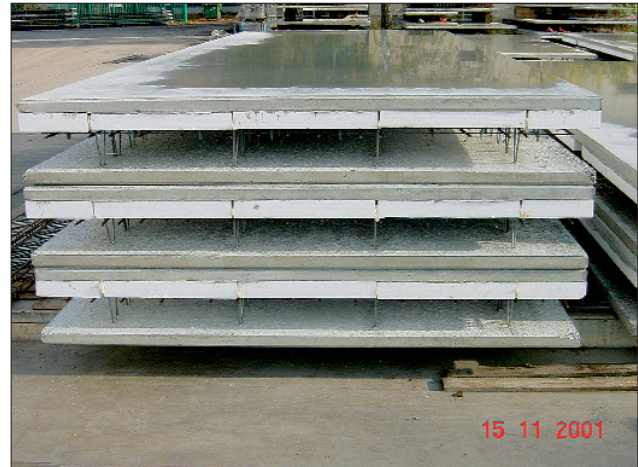
Abb. 3: Zulassungsgemäß hergestellte Thermo-Wände nach der Herstellung
