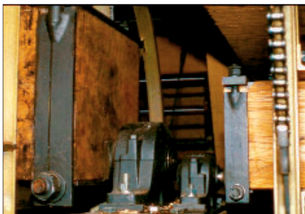
Abb. 2: Heute übliche Glockenauflagerung: Kugellager
