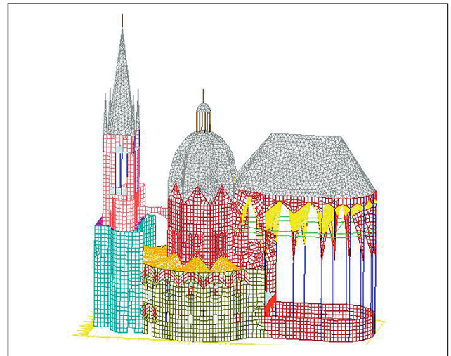
Abb. 10: Finite-Elemente Modell des Aachener Doms
