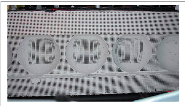
Abb. 17: Messfeld für photogrammetrische Messungen, Versuchskörper D2.2
