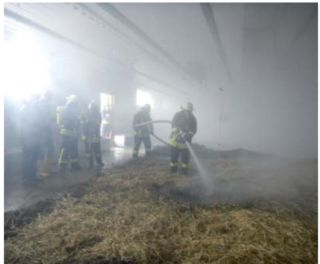
Abb. 15: Brandversuch mit Abbruch nach circa zehn Minuten durch den Einsatz der Feuerwehr und mit Einschaltung der maschinellen Lüftungsanlage
