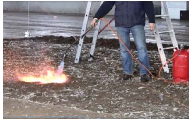
Abb. 9: Brandversuch zur Entflammung der Bodenschicht nach ca. 60 Minuten
