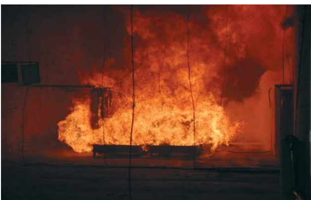
Abb. 2: Flüssigkeitslachenbrand (links) im Versuchstunnel der MFPA Leipzig (rechts)
