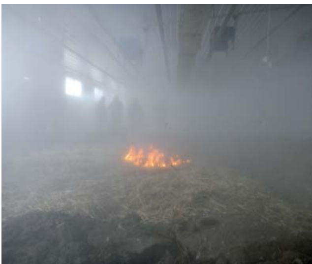
Abb. 13: Brandversuch nach circa drei Minuten mit bereits eingeschränkten Sichtverhältnissen durch die Wassernebelanlage
