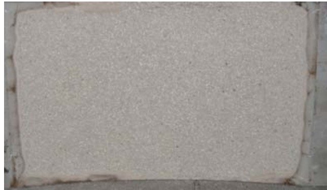
Abb. 8: Ergebnis einer EBA-Temperaturbeanspruchung bei geeigneter Betonrezeptur (maximale Abplatztiefe ca. 20 mm)
