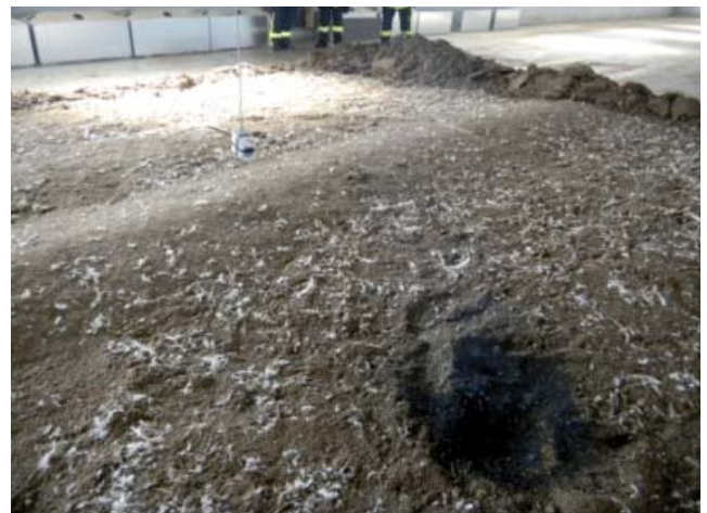
Abb. 10: Ende des Brandversuchs zur Entflammung der Bodenschicht
