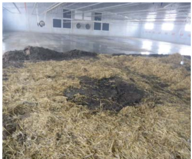
Abb. 16: Brandversuch nach weiteren vier Minuten wieder mit klaren Sichtverhältnissen durch den Einsatz der maschinellen Lüftungsanlage
