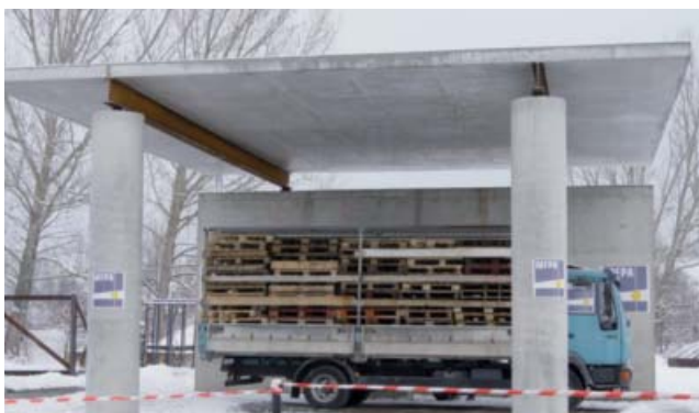
Abb. 3. Brückenbrandprüfstand und Versuchsaufbau
