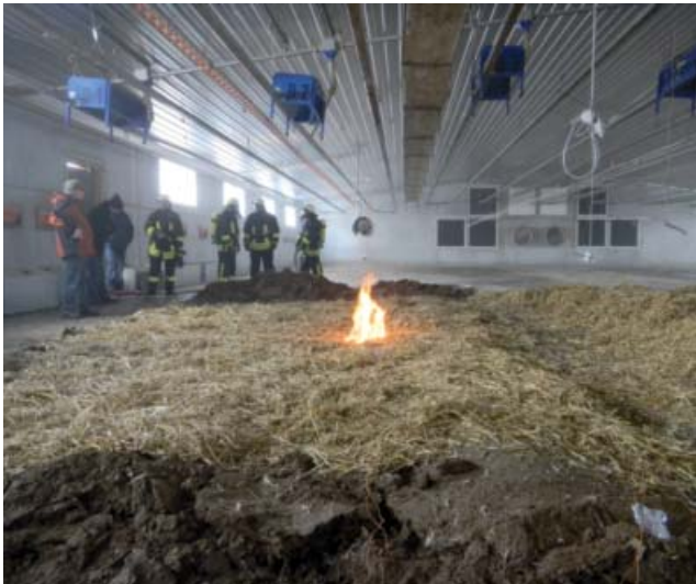
Abb. 11: Brandversuch nach circa einer Minute, im Hintergrund sind eine mobile Gaskanone und die Öffnungen der Abluftventilatoren zu erkennen
