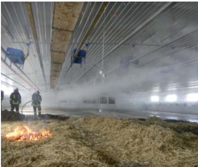
Abb. 12: Brandversuch nach circa 2,5 Minuten mit Auslösen der Wassernebelanlage
