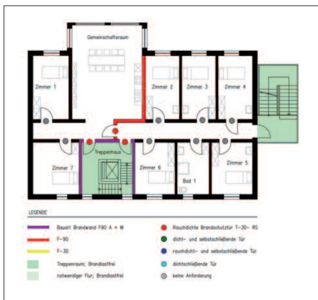
Abb. 4: Anforderungen gemäß Bauprüfdienst Hamburg für Wohngemeinschaften
