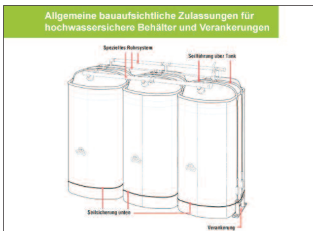
Abb. 3: Sicherungssystem zur Verhinderung des Auftriebs
