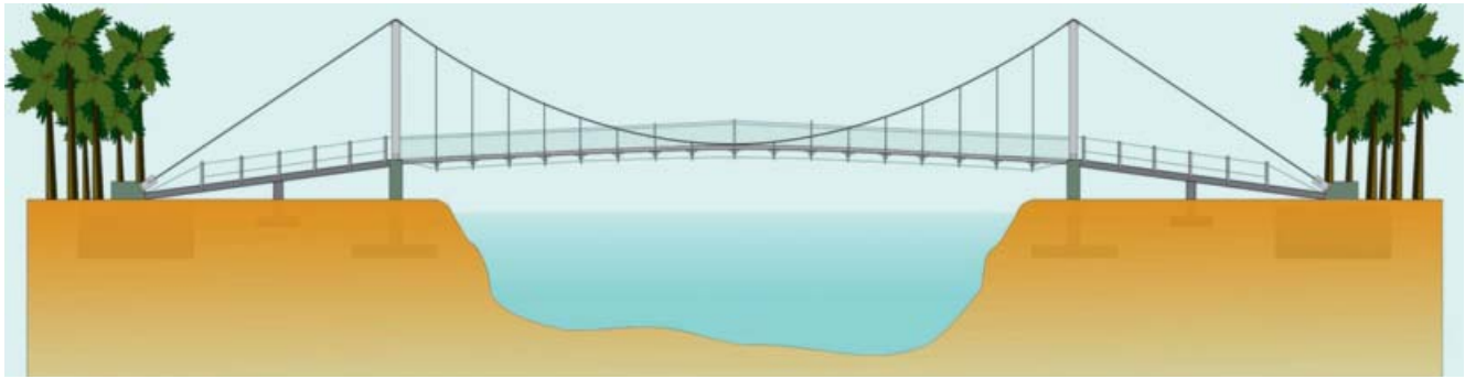
Abb. 4: DIE HÄNGEBRÜCKE über den Bentara-Fluss ist 60 Meter lang und wurde auf zwei Meter hohe Stahlbetonwände aufgebockt, die man über zwei jeweils zwölf Meter lange freitragende Rampen erreichen kann.
