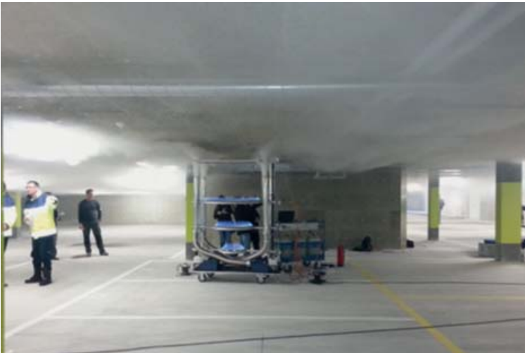
Abb. 2: Rauchversuch als Nachweis der Erfüllung bauordnungsrechtlicher Schutzziele
