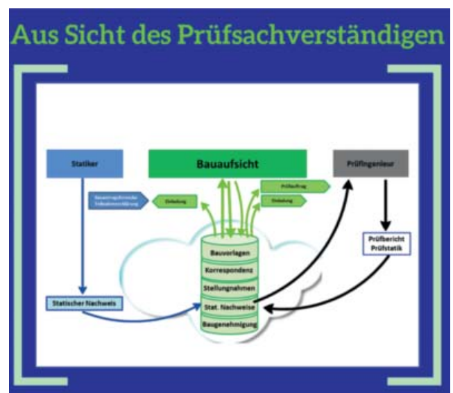
Abb. 3: Schema Elektronische Bauakte aus Sicht des Prüfingenieurs
