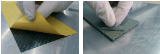
Abb. 23: Vergleich von Prepregs für carbonfaserverstärkte Kunststoffe (links) und Carbonbeton (rechts)
