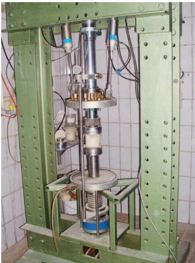
Abb. 3: Kriechen gefrorenen Bodens unter konstanter Spannung: links: Einaxialer Druckversuch am Institut für Bodenmechanik und Felsmechanik des Karlsruhe Instituts für Technologie mit angefrorenem Sand (oben die Probe, unten der Versuchsstand); rechts: Einaxiales Kriechen gefrorenen Sandes unter konstanter Druckspannung
