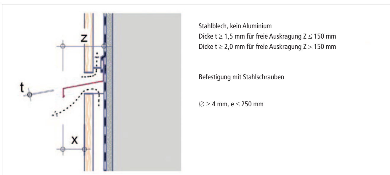
Abb. 5: Horizontale Brandschutzmaßnahme mittels Blechschürze nach [2]
